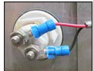
Fig. 32 - If equipped, tank sensor
