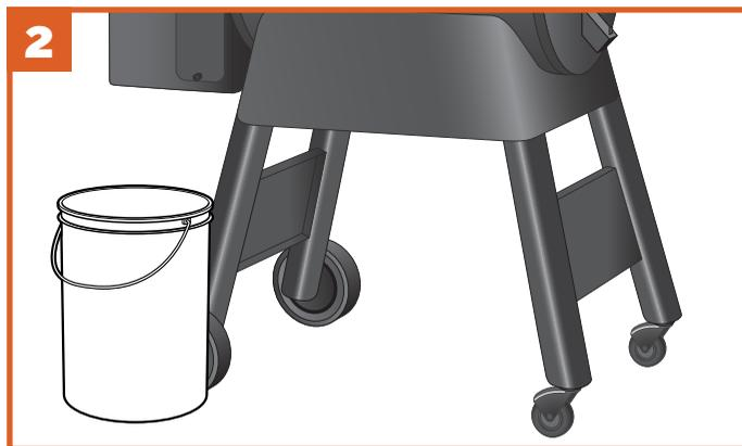
Placer un contenant assez grand pour contenir le contenu de la trémie sous la trappe de vidange des granules.
