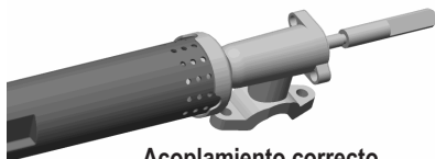
Acoplamiento correcto del quemador con la válvula
