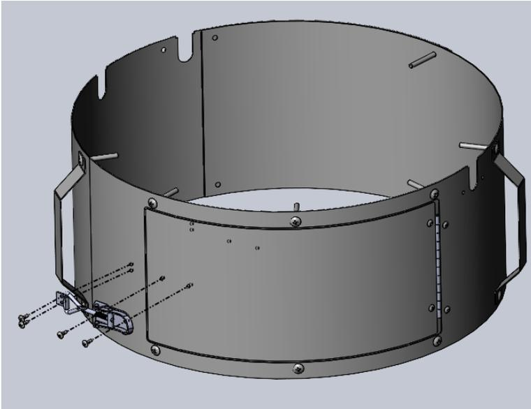
Terminer de placer les vis 2" avec écrous dans les trous restants
