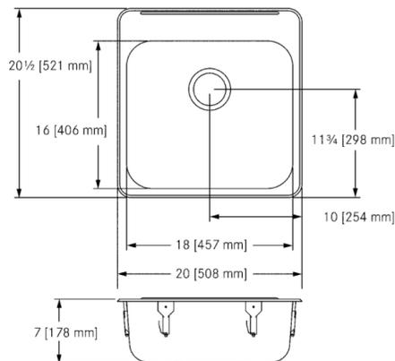
Évier à encastrer à un seul compartiment, à rebord incorporé, avec plage arrière pour robinet. Acier inoxydable type 302 (CNS 18/8), calibre 20 (0,9 mm). Les surfaces apparentes ont un fini satiné n° 4. Enduit sur la surface inférieure pour réduire la condensation et la résonance. Comprend un vidage, un joint de rebord appliqué en usine, un gabarit de découpage et des attaches EZ TORQUE installées en usine. Certification selon ASME A112.19.3-2008/CSA B45.4-08.
