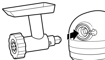
**3** Inserte el aditamento en el receptáculo de este, asegurándose de que el eje de potencia del aditamento encaje dentro de la cavidad cuadrada del receptáculo para aditamentos. Puede ser necesario girar el aditamento hacia atrás y hacia adelante. Cuando está en la posición correcta, la clavija del aditamento encajará en la muesca del borde del receptáculo.
