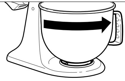
**2** **Retirer les accessoires :** Placer la commande de vitesse sur « 0 », débrancher le batteur sur socle et incliner la tête du moteur vers l'arrière; pousser ensuite l'accessoire vers le haut aussi loin que possible. Faire tourner l'accessoire en sens horaire, puis l'enlever de l'arbre du batteur.
