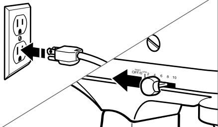
1 Enchufe la batidora con base en un tomacorriente de 3 terminales con descarga a tierra. Ajuste siempre la palanca de control de velocidad en la velocidad más baja para iniciar, después aumente la velocidad gradualmente para evitar salpicar ingredientes. Consulte la "Guía depara el control de velocidad" para seleccionar la mejor velocidad para su receta.
