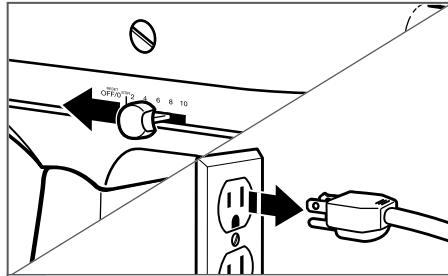
**1** Vérifier pour être certain que le batteur sur socle est débranché et que la commande de vitesse est à « 0 ».
