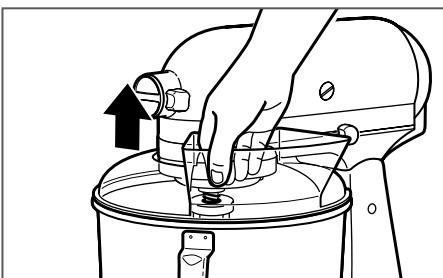
**(OPCIONAL) Retire el escudo vertedor\***: Levante la parte frontal del escudo vertedor\* hasta separarla del borde del tazón y sáquelo de la batidora con base.
